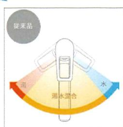
従来品のレバー中央部では水とお湯が混ざって出ます。しゃもじを濡らすだけでムダに給湯機が作動していました。
